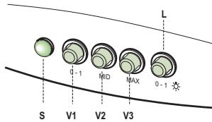
**L** Освещение Включает и выключает осветительное оборудование.
