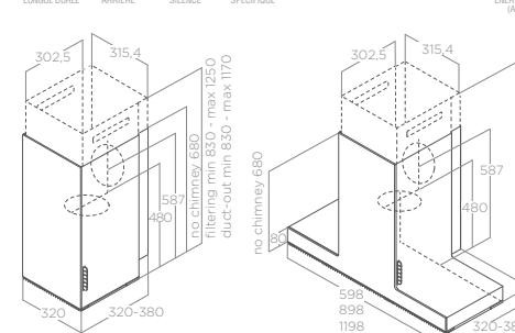
Installation possible, en version aspiration ou recyclage, sans l'aide de la cheminée supérieure, en restant à une hauteur de 680 mm.
