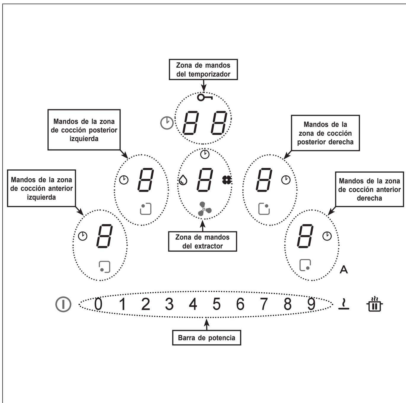
Los mandos de las zonas de cocción, del extractor y del temporizador se pueden activar pulsando el dígito de referencia
