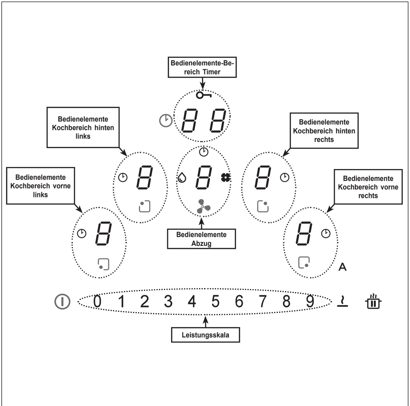
Die Bedienbereiche der Kochbereiche, der Abzugshaube und des Timers können durch Drücken der Referenz-Digit-Taste aktiviert werden . Die Bestätigung wird durch das stärkere Leuchten der Digit-Taste gegeben.
