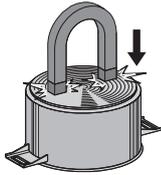
**Achtung:** verwenden Sie nur Töpfe mit einem perfekt flachem und für Induktionskochzonen geeigneten Boden. Die Verwendung von Töpfen mit unebenem Boden kann die Effizienz des Wärmestrahlungssystems beeinträchtigen und das Erkennen eines Topfes auf dem Kochbereich behindern.
