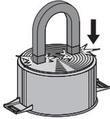
**Let op:** gebruik uitsluitend pannen met een perfect platte bodem die geschikt is voor inductiekookzones. Het gebruik van pannen met een onregelmatige bodem kan de efficiëntie van het warmtestralingssysteem ondermijnen en kan de pandetectie op de kookzone verhinderen.
