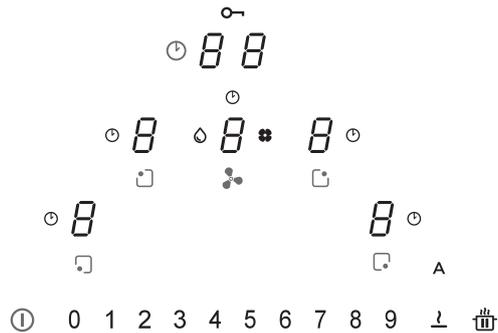
Nel primo allaccio alla rete domestica, l' installatore dovrà impostare la potenza dei fuochi del piano in considerazione delle reali possibilità e capacità della rete stessa. Se non risultasse necessario, possiamo andare direttamente ad accendere il piano tramite il tasto **ⓘ**, altrimenti seguire le operazioni sotto per entrare nel menu.
