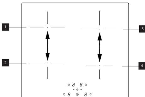
“Questo prodotto è dotato di una funzione di gestione della potenza a controllo elettronico.
