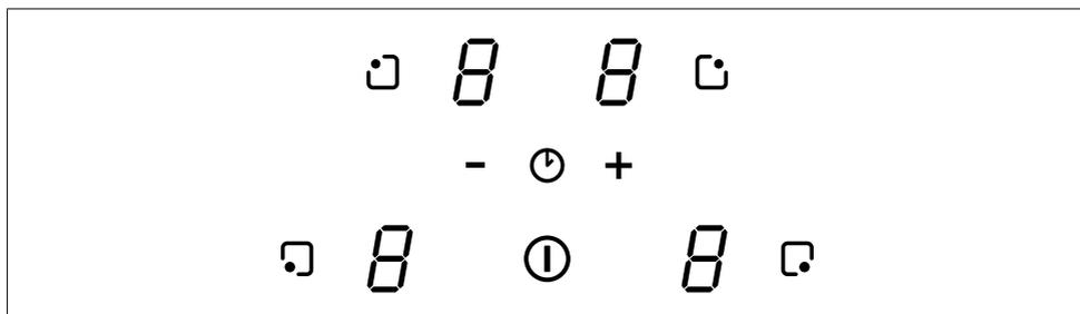
**Función de limitación de la potencia/tiempo** Esta función de seguridad sirve para apagar una zona de cocción que no ha sufrido cambios durante un cierto período de tiempo.
