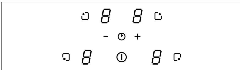
**Funktion zur Leistungs-/Zeitbegrenzung** Diese Sicherheitsfunktion ermöglicht das Abschalten einer Kochzone, die innerhalb einer bestimmten Zeitspanne keine Änderungen erfahren hat.
