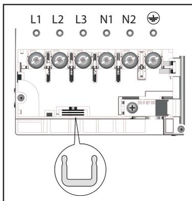
Insérer des dérivateurs de courant
