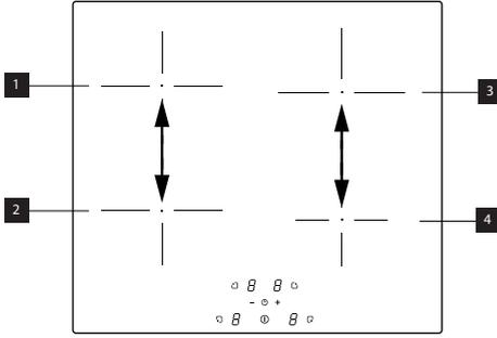
Bu ürün elektronik kontrollü güç yönetimi işlevi ile donatılmıştır. Şekle bakın.
